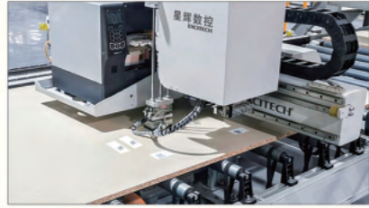
회전식 라벨링 장치, 자동으로 위치 조정 좁은 부분에 라벨을 붙입니다
