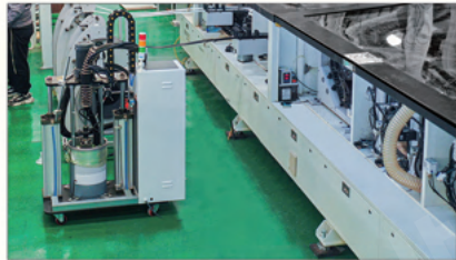
방수 및 제로 조인트 요구 사항에 사용 가능한 PUR 접착제 용융 장치
