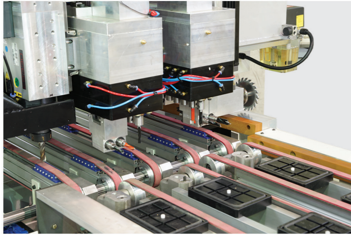
보링헤드 3,000~6,000RPM 조절가능, 주방 및 가구 자동라인
